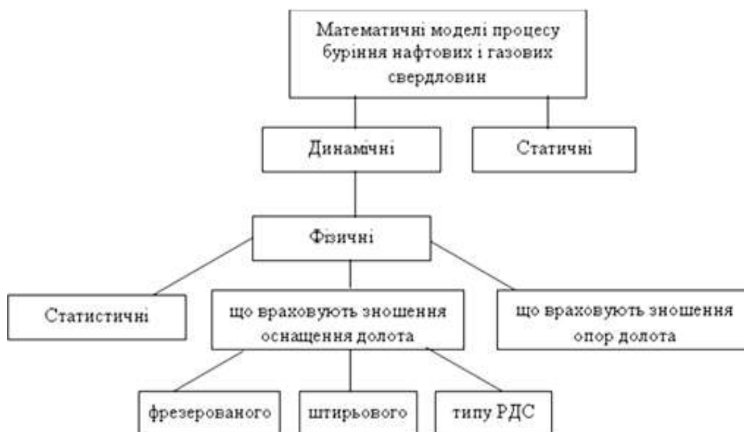
Рис. 5.1. Класифікація математичних моделей технологічного процесу буріння нафтових і газових свердловин
